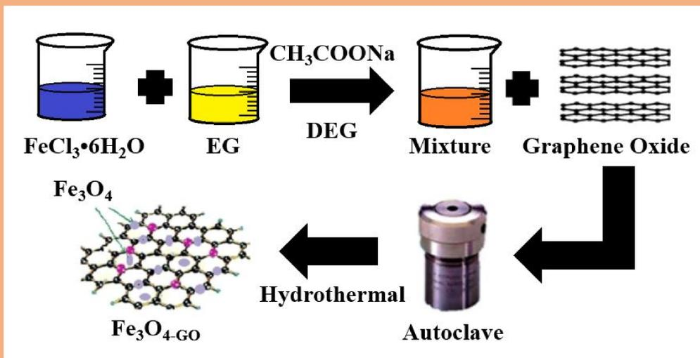
Figure 1. Fe<sub>3</sub>O<sub>4</sub>-GO 合成示意圖
