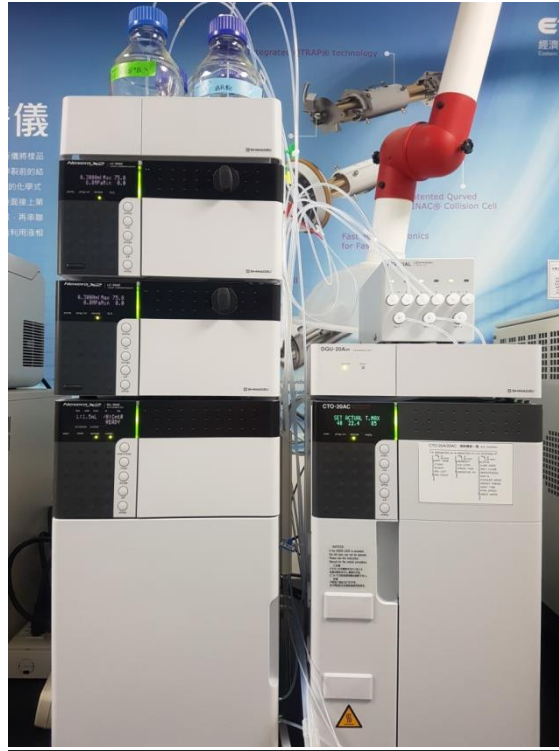
圖3. 層析管 Dikmatech HPLC，C18(2)，5 \mu\text{m} ，內徑 4.6 mm \times 150 mm。
