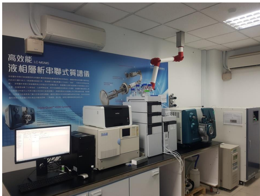
圖2. 液相層析串聯質譜儀 (LC/MS/MS) :含Shimadzu LC-30A與Ab SCIEX Triple Quad 4500 System設備。
