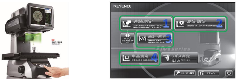
圖 3. (a) 基恩斯-快篩機；(b) 基恩斯-快篩機畫面之測定模式
