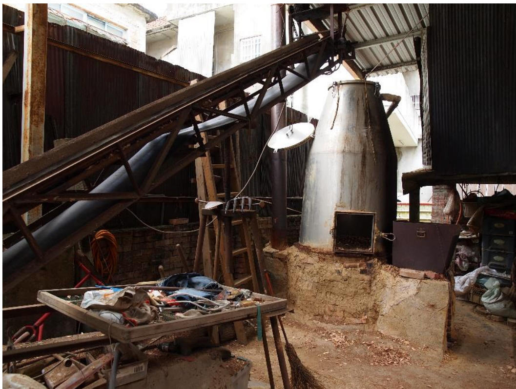
圖六:提煉樟腦用的鍋爐，下方燒柴，上方將樟木碎片放入，則可蒸煮出樟腦油，再
