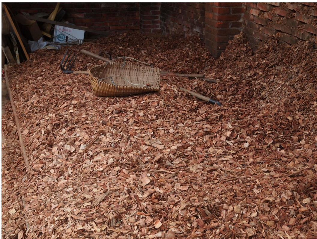
圖五:以機器刨製成碎片狀的樟木，供放入鍋爐內提煉樟腦。
