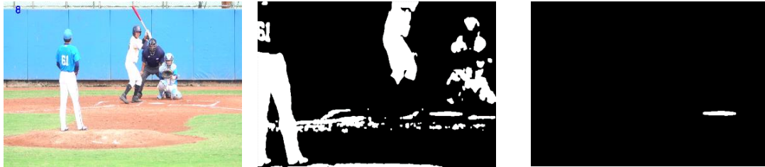
圖 6 a.原始影像 b.在幀中心的高強度像素 c.檢測本壘板
