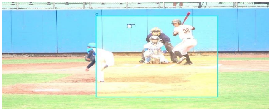
圖 12 YOLOv5 偵測區域縮小示意圖
