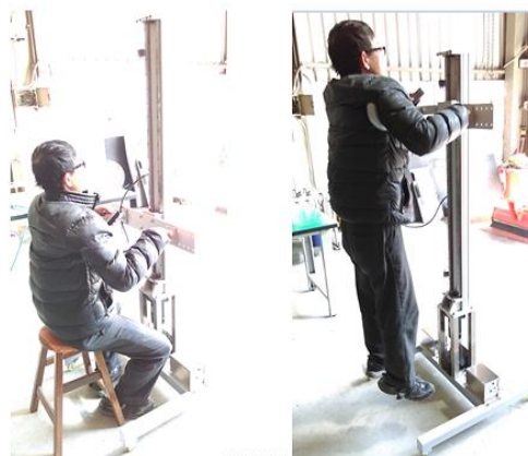
圖 16. 起身移動裝置測試(坐、站、懸空)
