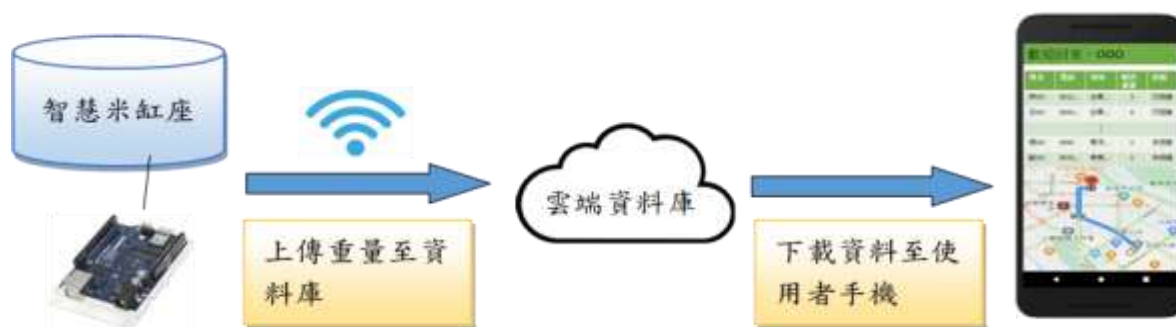
圖1.利用無線網路將米缸內重量上傳至資料庫流程圖
